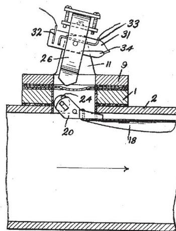
В 1931 году первый лопаточный переключатель с магнитным действием изобретает Луис Е. Ричмонд (патент США 1888737). Лопатка с металлическим роликом приводит в действие сбалансированный магнит с ртутным переключателем, расположенным снаружи.
