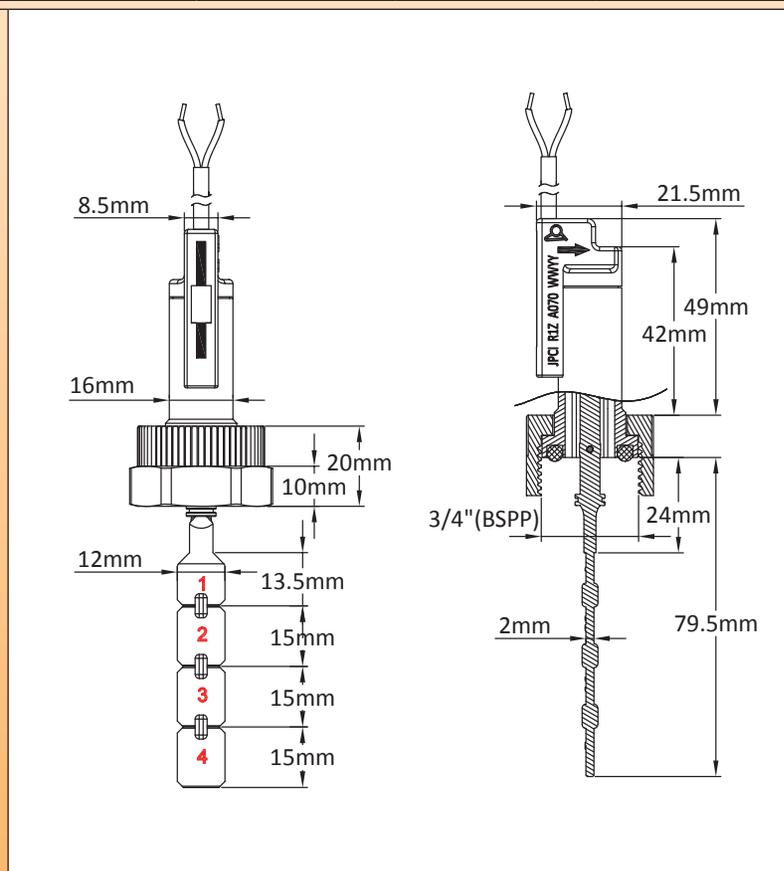
**Основное применение:** применение в больших количествах для обнаружения потока в низковольтных электронных схемах. Самая экономичная модель. Рекомендуемое монтажное положение - на горизонтальных трубах. Возможность установки в любом положении с небольшим отклонением в калибровке по причине веса лопатки. Может использоваться на водопроводных трубах диаметром от 15 до 100 мм.
