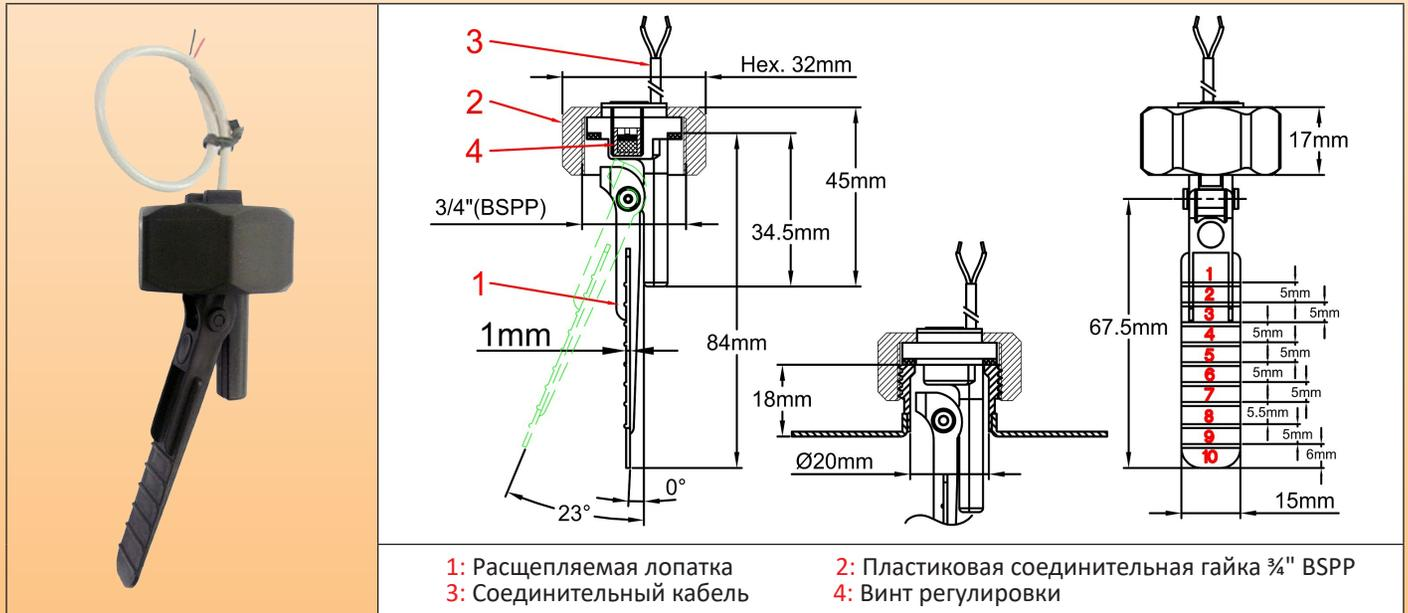
**Основное применение:** самый простой переключатель потока с магнитным отводом. Рекомендуемое положение монтажа - на горизонтальных трубах, но может быть установлен в любом положении. Для обнаружения потока воды на водопроводных трубах **диаметром от 25 до 100 мм**
