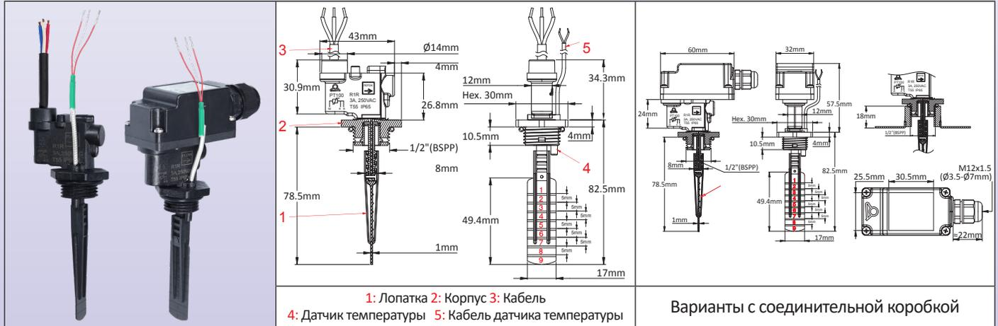
**Основное применение:** обнаружение потока воды в водопроводных трубах, с одновременным измерением температуры воды
