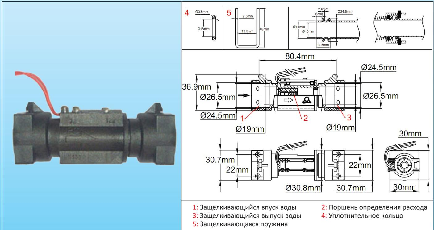
**Основные области применения:** изделие разработано для электрических или газовых водонагревателей мгновенного действия. Защелки для ввода и вывода воды для медных труб. Обязательный вертикальный монтаж, с подводом воды снизу.
