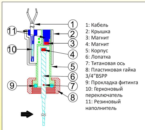
2 магнита, регулируемые настройки, внешний механизм
